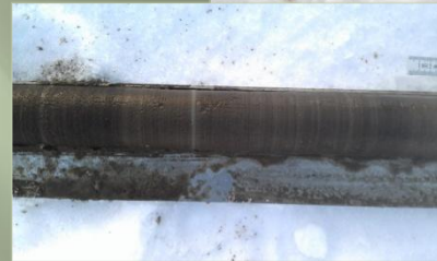
En sjösedimentsprovtagning med Russian Sampler under vintern. Bild 1: Timo Saarinen, Turun Yliopisto, Bild 2: Petra Lignell Abo Akademi
